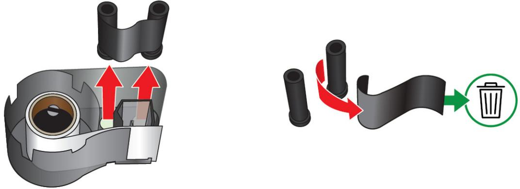
5. Levante las etiquetas de la carcasa del cartucho y, a continuación, retire el cilindro de plástico negro del interior del núcleo de la etiqueta.
