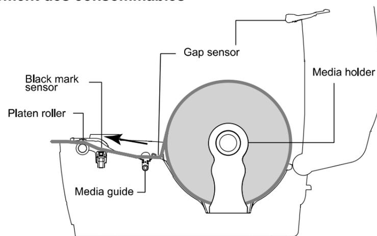
(7) Utilisez "Diagnostic Tool" (Outil de diagnostic) pour régler le type de capteur de consommable et calibrez le capteur sélectionné. (Lancez "Diagnostic tool" (Outil de diagnostic) Sélectionnez l'onglet "Printer Configuration" (Configuration imprimante) Cliquez sur le bouton "Calibrate Sensor" (Calibrer le capteur)). Référez-vous au guide de mise en route de l'outil de diagnostic pour plus d'informations.
