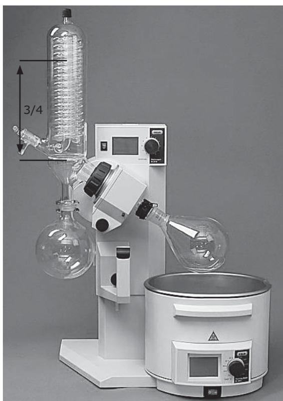
Fig. 6.2: Zone de condensation optionnelle d'un réfrigérant
