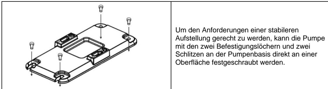
Um den Anforderungen einer stabileren Aufstellung gerecht zu werden, kann die Pumpe mit den zwei Befestigungslöchern und zwei Schlitzen an der Pumpenbasis direkt an einer Oberfläche festgeschraubt werden.
