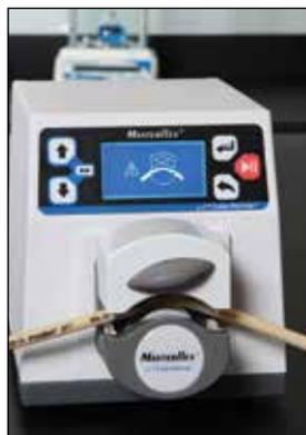
Un capteur de tête ouverte coupe le moteur lorsque la tête de pompe est ouverte.
