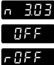
Während des darauf folgenden Selbsttests leuchten alle Segmente des vierstöckigen MULTI-DISPLAY und alle Kontroll-Leuchten. Es erfolgt kurz die Anzeige der Versionsnummer der Software (Beispiel: n 3.03) und mit der Meldung "OFF" bzw. "rOFF" wird danach die Betriebsbereitschaft angezeigt.
