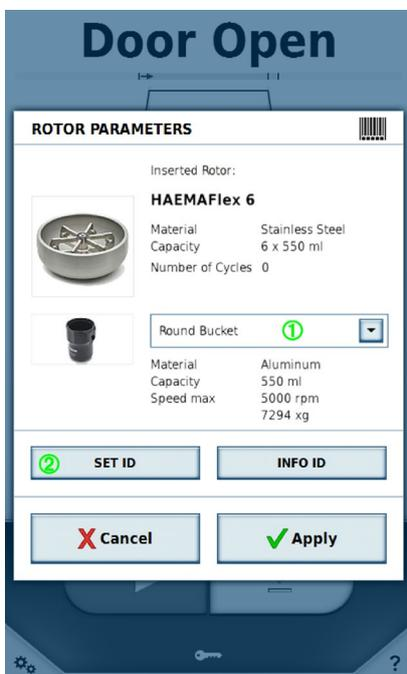
С помощью кнопки **Задать идент. номер** ② вводят серийные номера или считывают их сканером штрихкодов.
