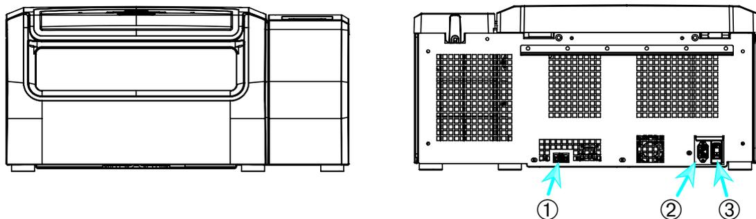
① RS232; ② Netzanschluss; ③ Netzschalter
