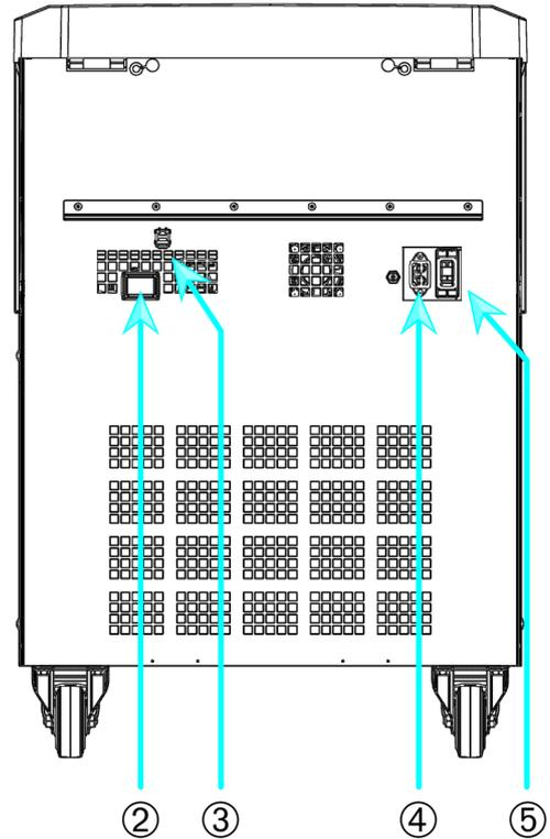
① USB; ② RS232; ③ Ethernet; ④ Netzanschluss; ⑤ Netzschalter
