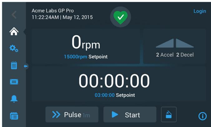
Abbildung 3–5: Startseite der Zentrifuge im Leerlaufbetrieb
