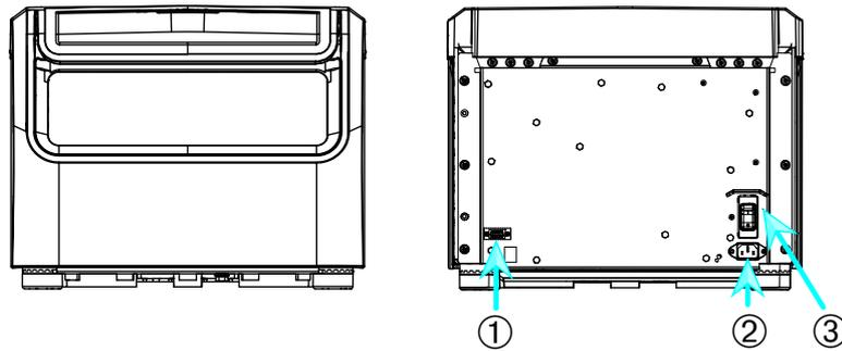
① RS232; ② Netzanschluss; ③ Netzschalter
