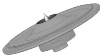
Abbildung 2–19: Deckel eines aerosoldichten Rotors mit Dorn
