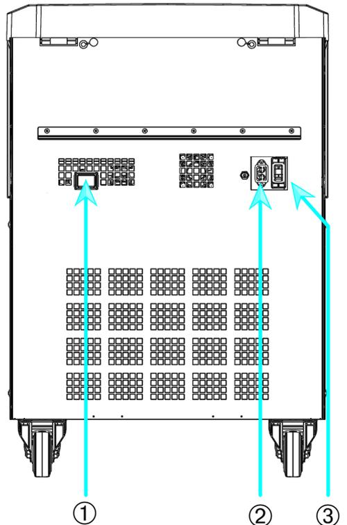
① RS232; ② Netzanschluss; ③ Netzschalter
