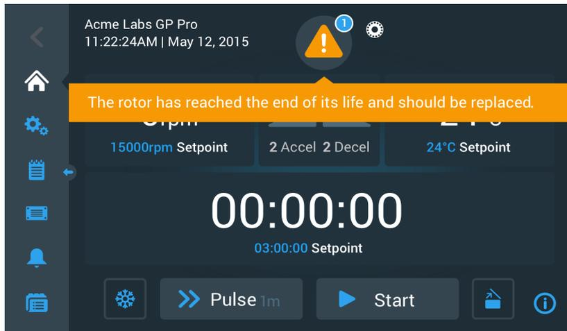
Abbildung 3–27: Warnmeldung Ende der Rotor-Nutzungsdauer oben auf der Startseite
