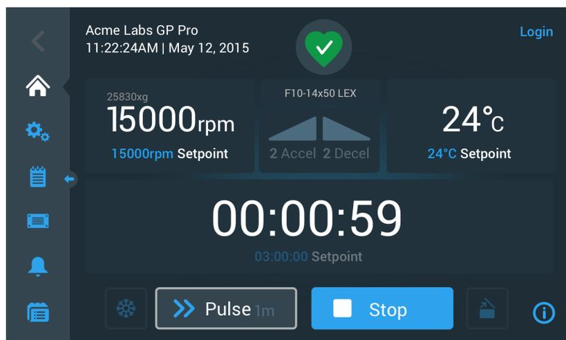
Abbildung 3–25: Pulse-Modus: Zentrifuge läuft eine Minute lang
