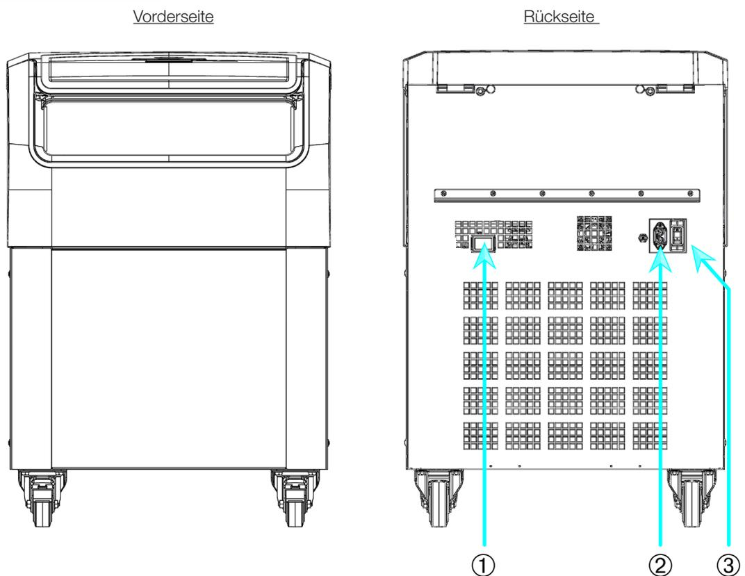
① RS232; ② Netzanschluss; ③ Netzschalter
