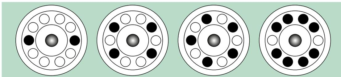
Abbildung 2-13: Beispiele für die richtige Beladung von Festwinkelrotoren
