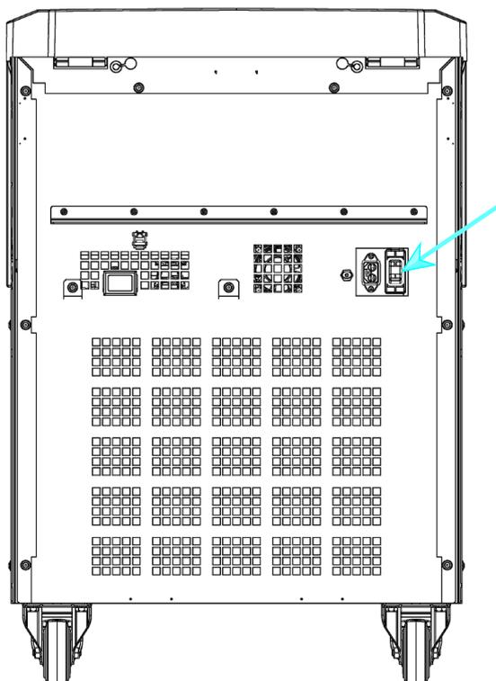
Abbildung 2-7: Rückansicht der Standzentrifuge, Lage des Netzschalters
