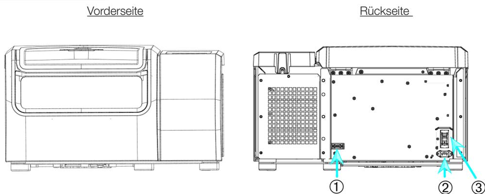
① RS232; ② Netzanschluss; ③ Netzschalter
