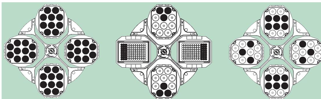
Abbildung 2-14: Beispiele für die richtige Beladung von Ausschwingrotoren
