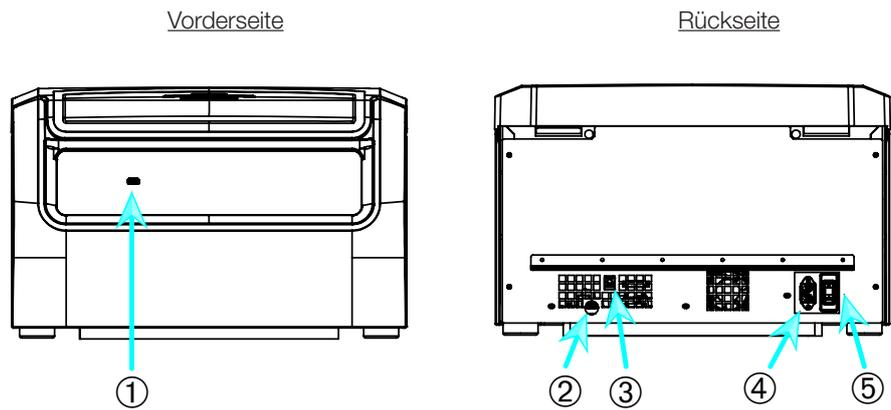
① USB; ② RS232; ③ Ethernet; ④ Netzanschluss; ⑤ Netzschalter
