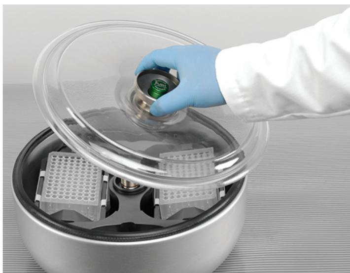
Abbildung 2–8: Rotordeckel aufsetzen/abnehmen.
