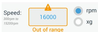
Abbildung 3-62: Einstellungen -> Bedienelemente -> Seite Sollwerte: Warnmeldung Wert liegt außerhalb des zulässigen Bereichs
