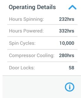
Abbildung 3–35: Seite Status – Alarmmeldung: Erweiterte Ansicht der Betriebsdetails
