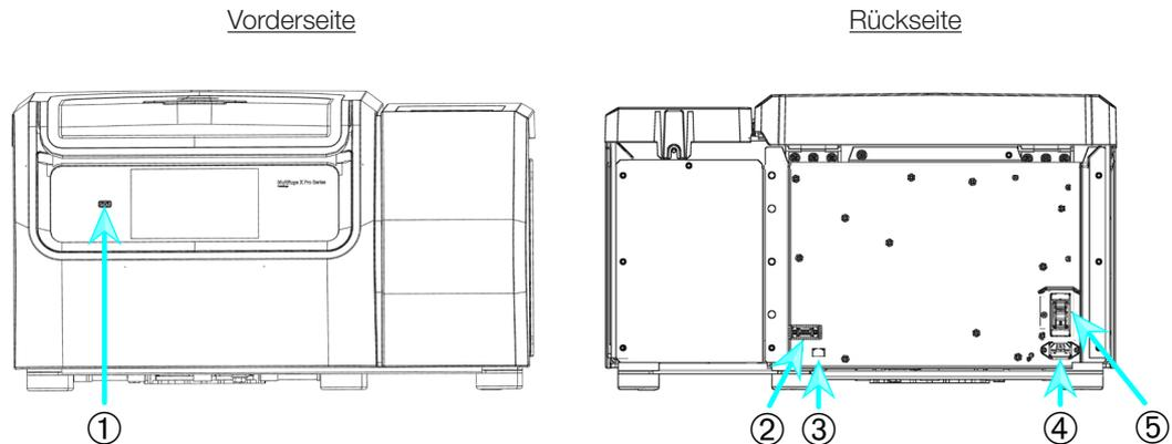
① USB; ② RS232; ③ Ethernet; ④ Netzanschluss; ⑤ Netzschalter
