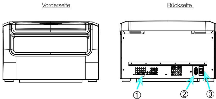
① RS232; ② Netzanschluss; ③ Netzschalter
