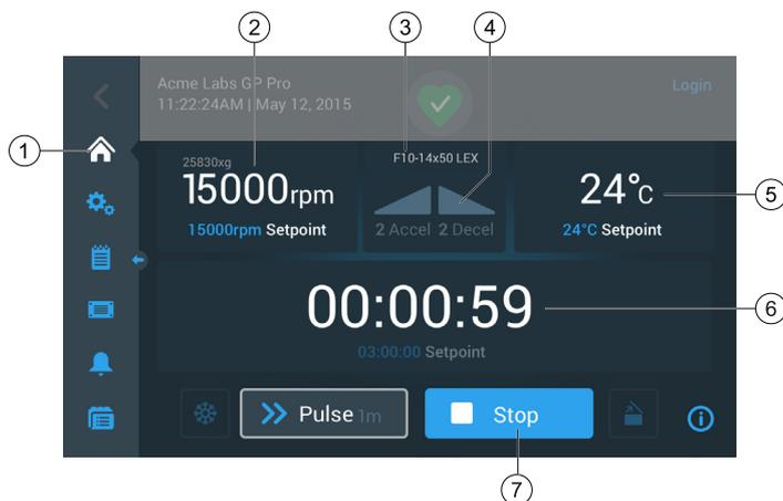
Abbildung 3-7: Startseite einer gekühlten Zentrifuge im Betrieb
