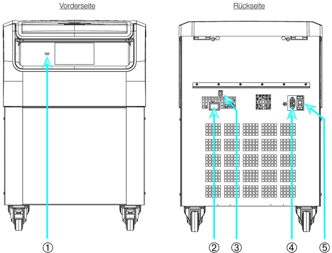
① USB; ② RS232; ③ Ethernet; ④ Netzanschluss; ⑤ Netzschalter
