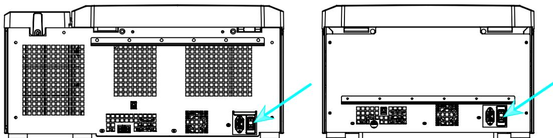
Abbildung 2-6: Rückansicht der Tischzentrifuge, Lage des Netzschalters
