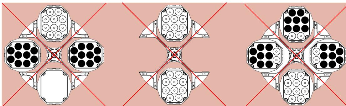
Abbildung 2-16: Beispiele für die falsche Beladung von Ausschwingrotoren
