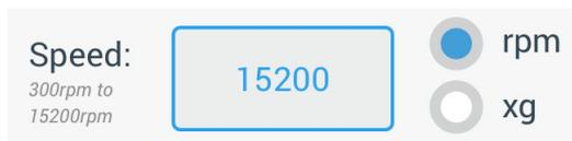
Abbildung 3–15: Seite Sollwerte, Detailansicht der Zentrifugendrehzahl und des Bereichs
