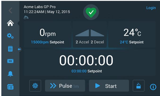
Abbildung 3–3: Touchscreen-Display einer gekühlten Zentrifuge
