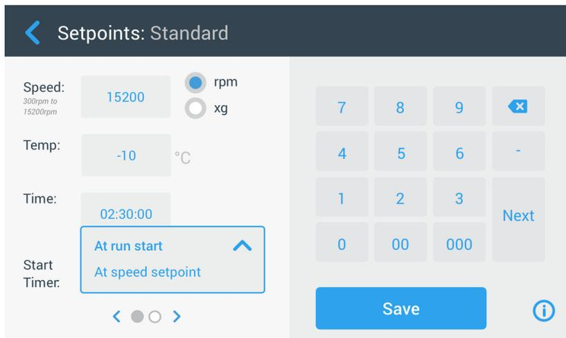
Abbildung 3-13: Seite Sollwerte: Standard einer gekühlten Zentrifuge
