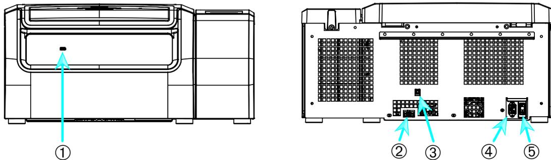
① USB; ② RS232; ③ Ethernet; ④ Netzanschluss; ⑤ Netzschalter
