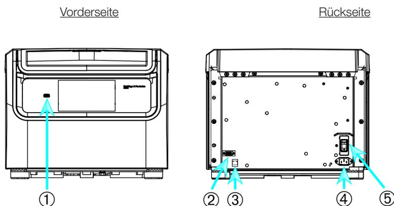
① USB; ② RS232; ③ Ethernet; ④ Netzanschluss; ⑤ Netzschalter
