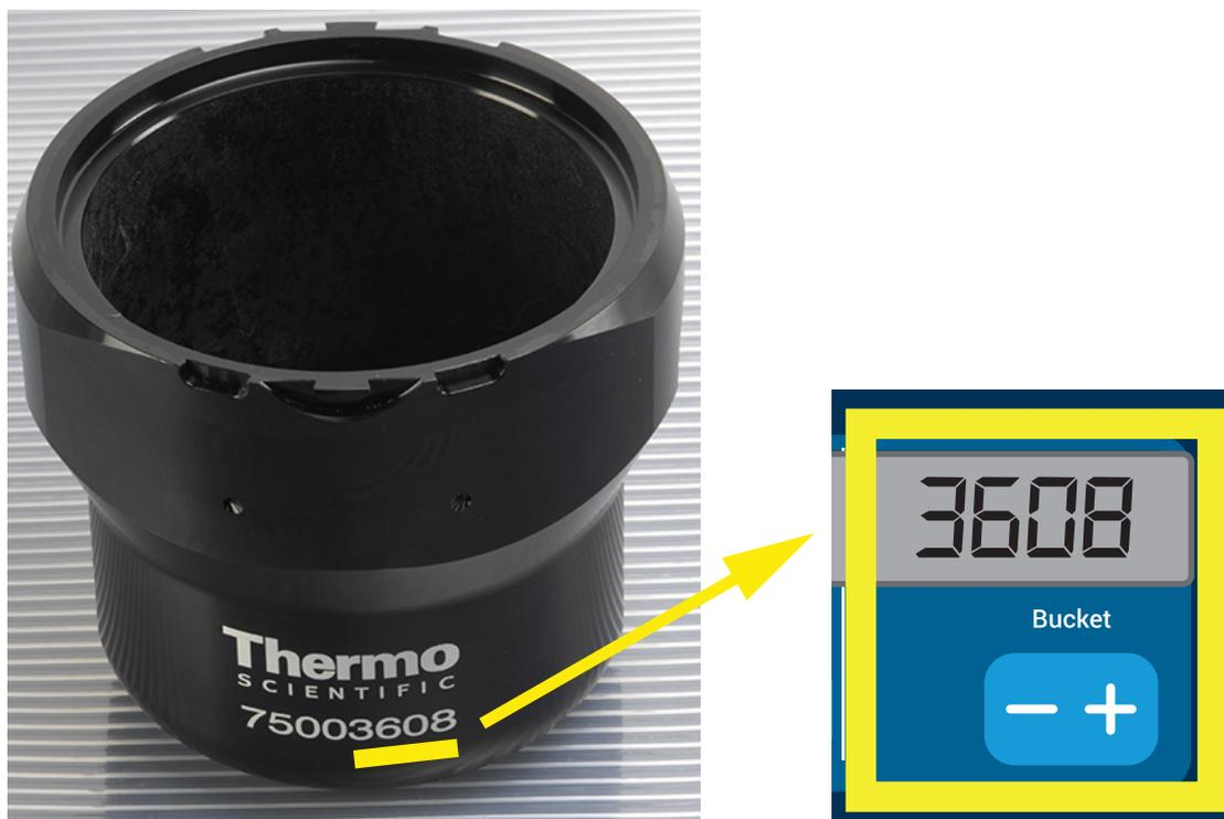
Abbildung 2-18: Korrekten Bechercode für den Rotor einstellen
