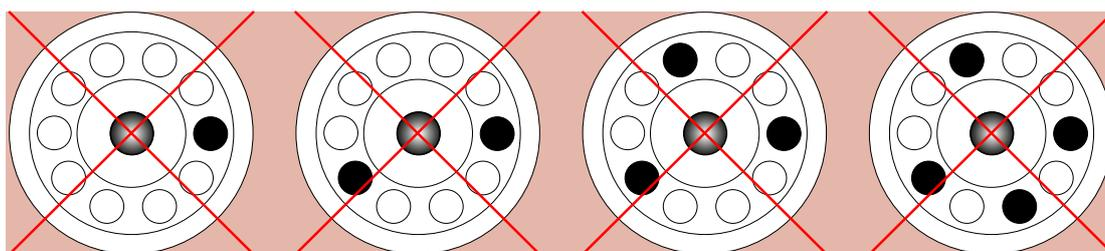
Abbildung 2-15: Beispiele für die falsche Beladung von Festwinkelrotoren
