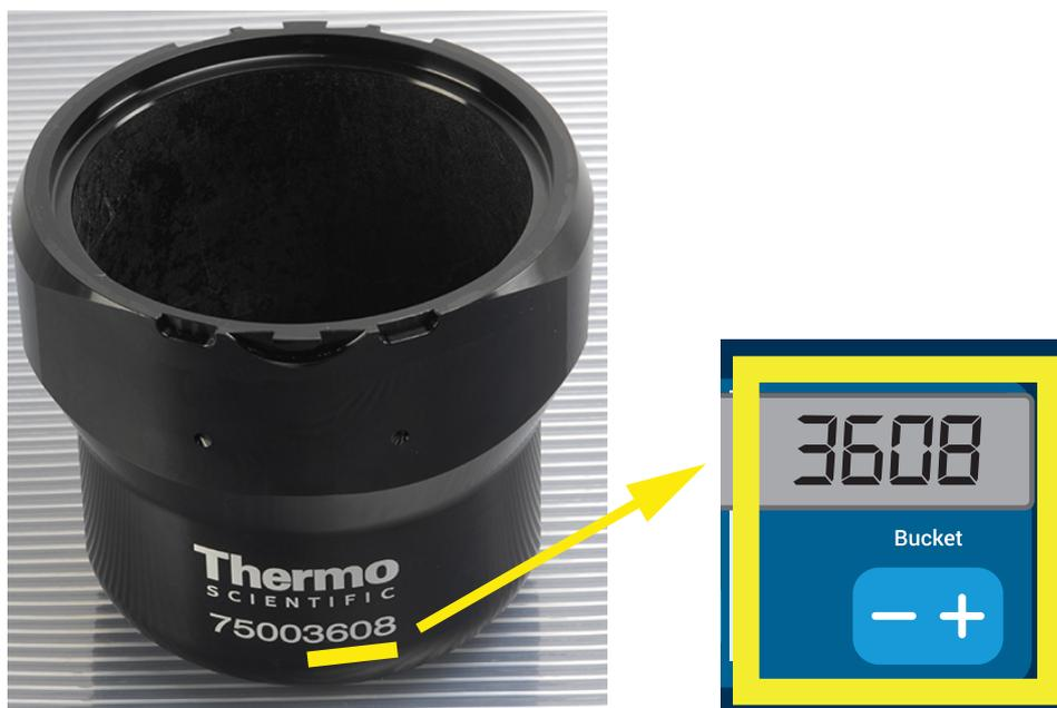
Figura 4-8: Impostazione del codice corretto del cestello per il rotore
