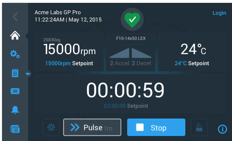
Figura 3-25: Modo Pulso: centrifuga en marcha durante un minuto
