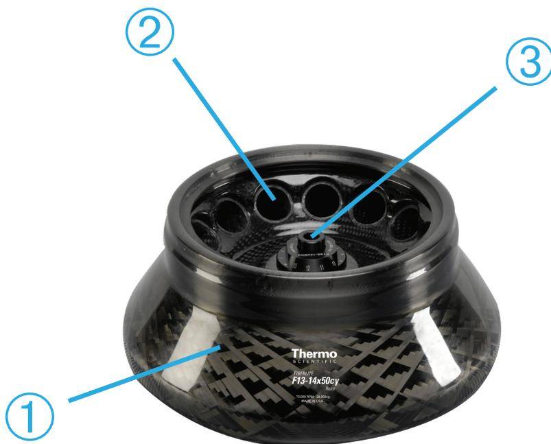
① Rotorkörper; ② Hohlraum; ③ Rotordeckelaufnahme
