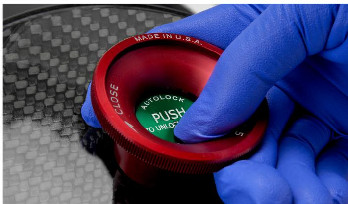
Abbildung 2-10: Betätigung der Auto-Lock-Taste
