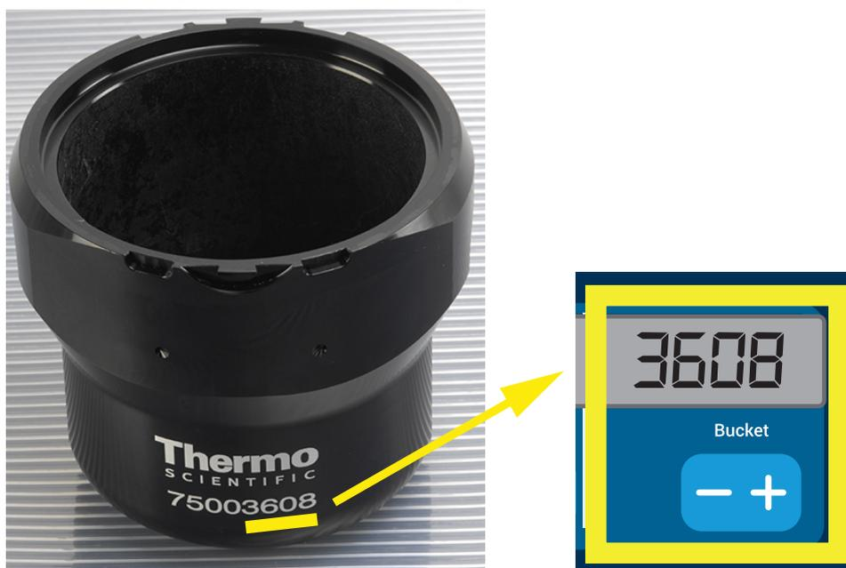
Abbildung 3–8: Korrekten Bechercode für den Rotor einstellen
