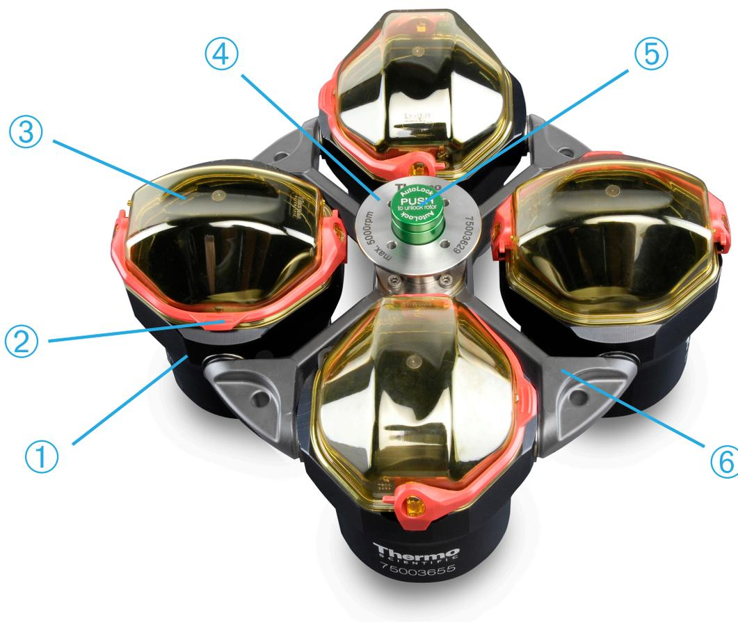
① Nacelle ; ② Verrou de capuchon ; ③ Capuchon de nacelle ; ④ Sélecteur de rotor ; ⑤ Bouton auto-verrouillage ; ⑥ Croisillon de rotor
