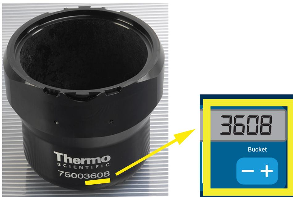
Figura 3-8: Impostazione del codice corretto del cestello per il rotore
