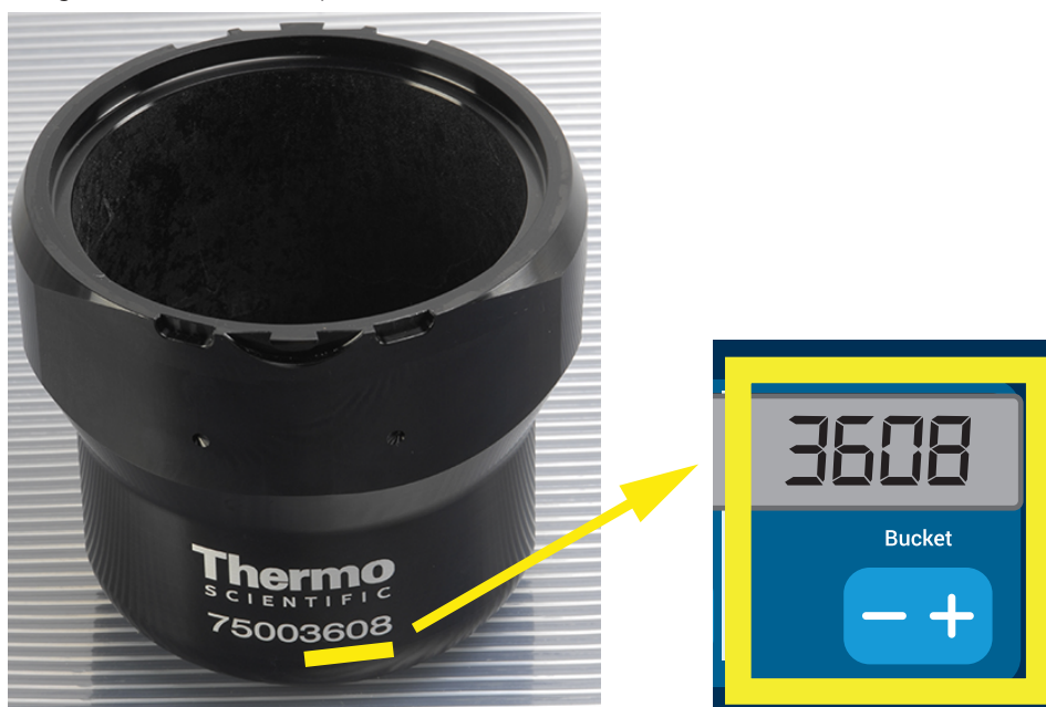
Figura 3-8: Ajuste del código de cubeta correcto para el rotor
