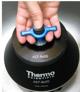
Abbildung 25: Halten des Rotors während der Entnahme
