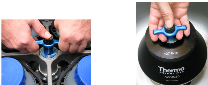
Figura 25: Tenere il rotore mentre viene rimosso
