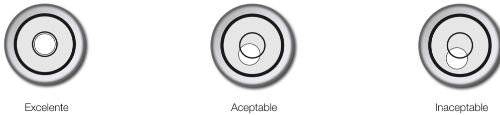
Figura 6: Posición de la burbuja en el nivel
