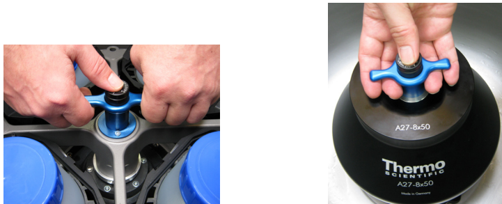
Figura 25: Sujeción del rotor durante el desmontaje
