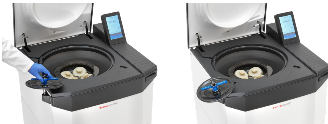
Figura 29: Utilización del soporte de la tapa del rotor Auto-Lock
