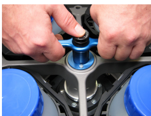
Bild 25: Handgrepp för att ta bort rotorn
