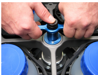
25. ábra: A forgórész megtartása a kivétel során
