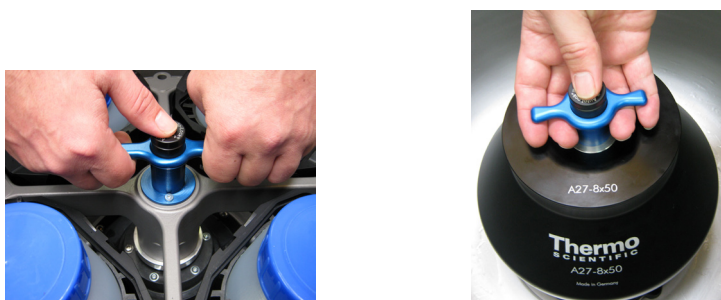
Figur 25: Hvordan rotoren holdes ved fjerning
