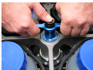
図 25: ローターを取り外すときのホールド方法
