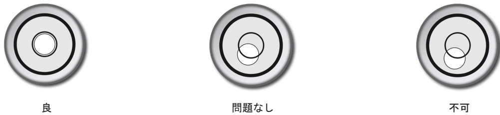
図 6: 気泡水準器の気泡の位置
