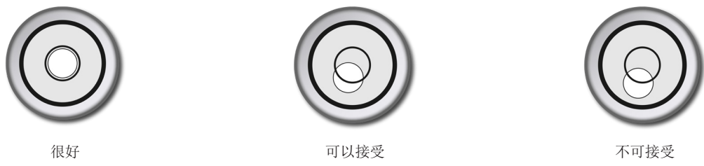
图 6: 气泡在水准仪中的位置
