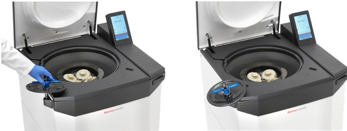
图 29: 使用自动锁定转子盖支架
