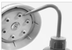
Ispirite destiliranom vodom.
