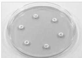
Precyzyjne pozycjonowanie krążków równomiernie rozmieszczonych na okręgu o średnicy 54 mm.
