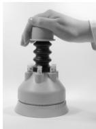
Enfoncer le piston dans un mouvement continu complet et régulier vers le bas et le relâcher. Ne pas exercer de pression excessive sur le piston.
