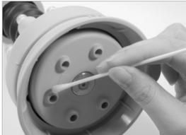
*Używać wyłącznie rozcieńzonego (2%) nietoksycznego środka dezynfekującego zawierającego czwartorzędowe sole amonowe lub rozcieńzonego (1%) roztworu podchlorynu sodu. Za pomocą wacika wyczyścić spód dozownika i otwory wyrzutowe.*
