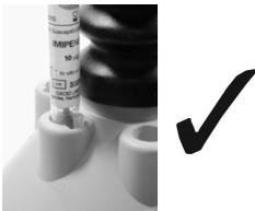
3. Kontrollér, at kassetten er isat korrekt.
