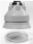
Coloque el dispensador sobre la placa de Petri.
