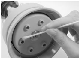
*N'utilisez* que du désinfectant non toxique à base de sel d'ammonium quaternaire dilué (2 %) ou hypochlorite de sodium dilué (1 %). Utilisez un écouvillon pour nettoyer le dessous du distributeur et les trous d'éjection.
