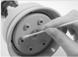
Utilizzare *solo* una soluzione disinfettante a base di sale di ammonio quaternario non tossico diluito (2%) o ipoclorito di sodio diluito (1%). Pulire con un tampone la parte inferiore del dispenser e i fori di espulsione.
