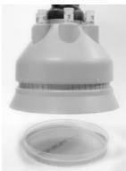
Coloque o dispensador sobre a placa de Petri.
