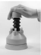
Drücken Sie den Kolben in einer vollen und gleichmäßigen Abwärtsbewegung nach unten und lassen Sie ihn los. Üben Sie keinen übermäßigen Druck auf den Stößel aus.
