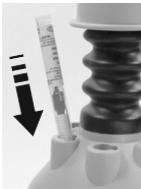
Kartuschen laden: Stellen Sie sicher, dass sie mit einem positiven „Klick“ einrasten.
